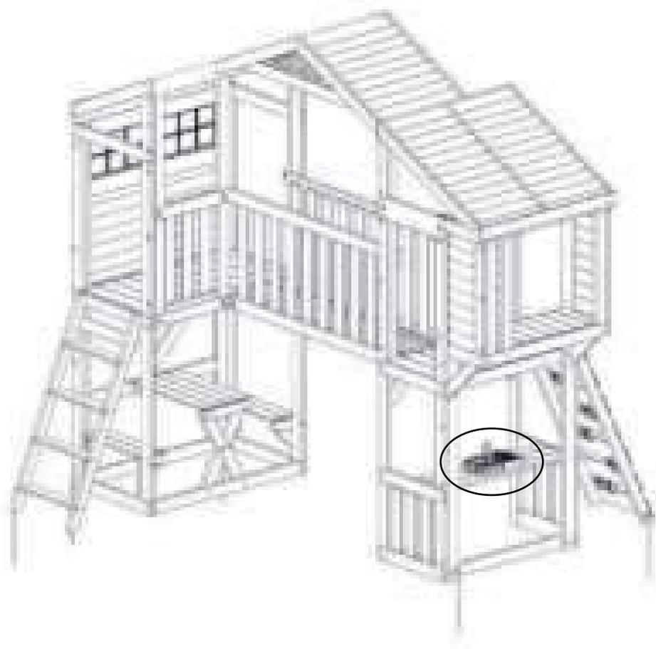
重要：手持ち式のスクリュードライバーを使用し、締め付けすぎないようにしてください。
