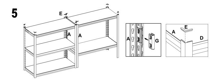
注意:付属の転倒防止用金具は、木製スタッドウォール構造用であり、壁の間柱に取り付ける必要があります。壁の構造によっては、別のアンカー金具が必要になる場合があります。お近くの金物店までお問い合わせください。ラックの転倒により重傷を負う可能性があります。ラックの転倒およびそれに伴う事故や破損を防ぐために、転倒防止金具を適切に取り付ける必要があります。転倒防止は耐震には対応していません。
